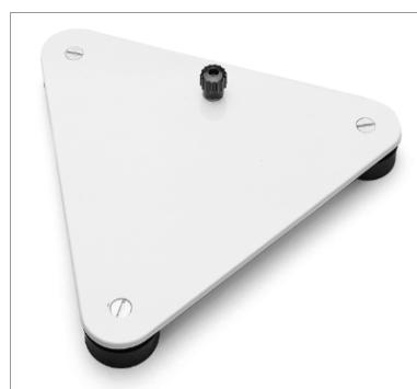
Die Fußbodensonde 1081 ermöglicht die Messung des Widerstands isolierender Fußböden gemäß DIN VDE 0100 Teil 610 und EN 1081.
