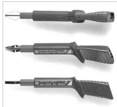
Drei selbsthaltende Prüfspitzen mit Berührungsenschutz zum Anschluss von Messleitungen mit 4 mm-Bananensteckern bzw. mit berührungsgeschützten Steckern an Buchsen mit Öffnungen von 3,5 mm bis 12 mm, z. B. CEE-, Perilex-Steckdosen usw.
