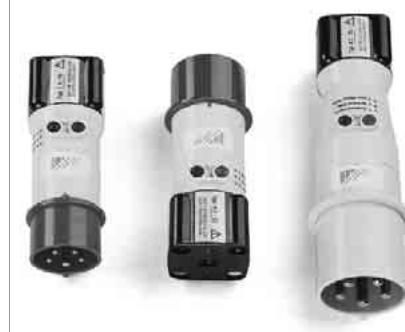
Die Drehstromadapter A3-16, A3-32 und A3-63 dienen dem problemlosen Anschließen von Prüfgeräten an 5-polige CEE-Steckdosen. Die drei Ausführungen unterscheiden sich durch die Größe des Steckers, der jeweils die 5-poligen CEE-Steckdosen mit den Nennströmen 16 A, 32 A, 63 A entspricht. Die Phasenfolge wird jeweils durch Lampen signalisiert.
